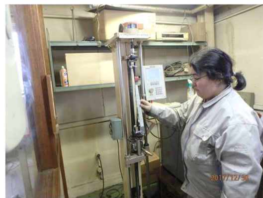
●JIS K 6251 および JIS K 6253 に基づく、引張試験と硬度試験を実施
