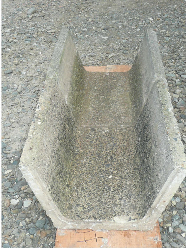
摩耗により骨材が露出水路
